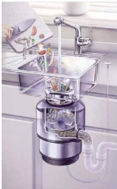
Fig. 1: Grafikk av matavfallskvernen i bruk. Merk ingen kniver og integrert luftbryter for enklere montering og bedre beskyttelse mot elektrisk støt, se også fig. 2.
